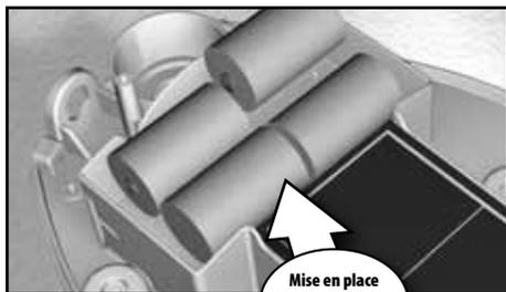
Equipez votre alarme Immerstar® des 4 piles alcalines se trouvant dans le carton d'emballage en respectant les polarités. Le logement est prévu pour bloquer les piles dans leur position de fonctionnement : clipsez-les en exerçant une bonne pression.
