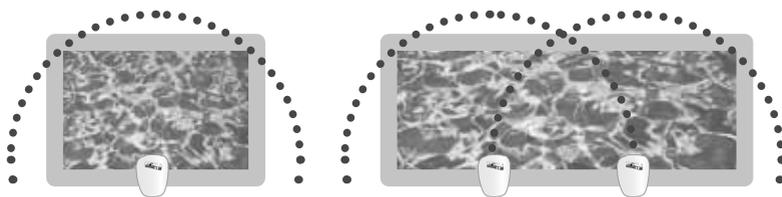
• La norme NFP 90-307-1:2009 relative aux alarmes de piscines impose la détection de toute chute dans un délai maximal de 12 secondes : l'alarme Immerstar® ne peut donc pas être située à plus de 7 mètres d'un point de chute potentiel.
